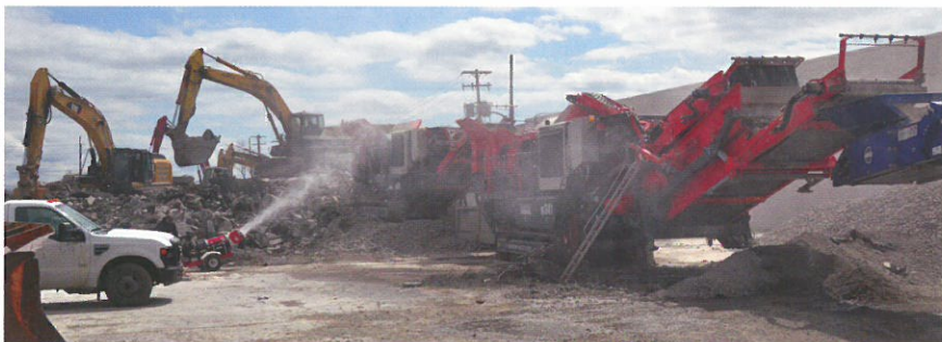
Fukar Buffalo s vlastním motorem vytváří jemnou mlhu a odnáší jemné prachové částice mimo pracovní místo. Obsluha stroje lépe vidí.
