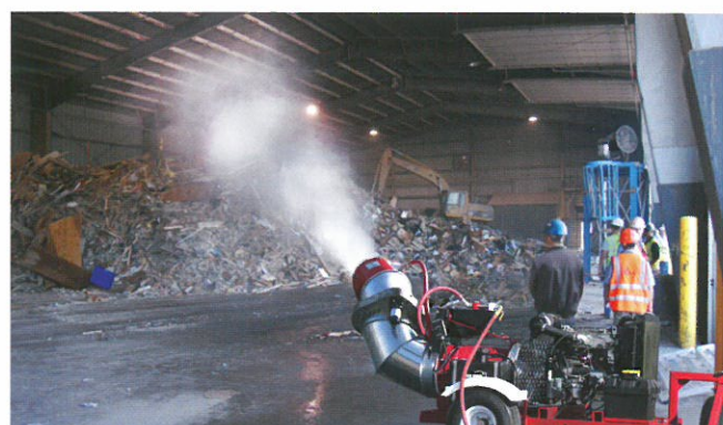
Fukar Buffalo s dieselovým pohonem umístěn v prašném vnitřním prostředí zlepšuje hygienické a pracovní podmínky.
